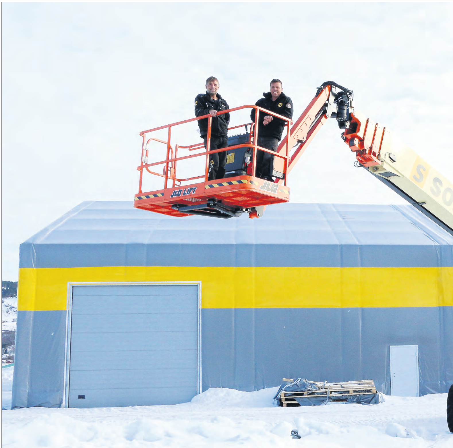
Stig Solem (til høyre) og Cato Næss prøvekjører den nyeste liften. Solem tror dette er Orkdals største. Den er 20 tonn tung og strekker 43 meter opp i lufta på
